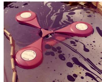
Equipé de 3 flotteurs, le skimmer est profilé pour une efficacité optimum du captage de l'effluent flottant vers le cône déversoir
