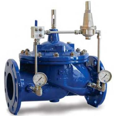
**La vanne de régulation Type XLC 410 permettra de réduire et stabiliser la pression aval à une valeur prédéfinie , indépendamment des variations du débit et des fluctuations de pression en amont .**
