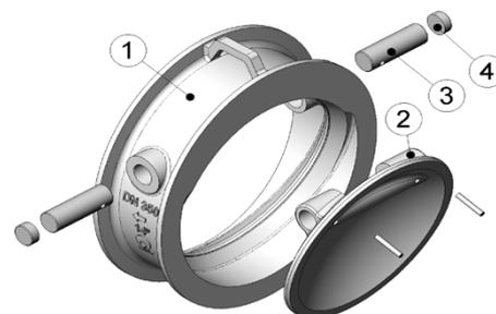
D'autres matériaux comme la fonte nodulaire GJS-500 et les alliages d'acier inoxydable (AISI316Ti, Duplex, 254SMO, Uranus B6 ....) sont disponibles sur commande. en acier au carbone sont peints avec une protection anticorrosive de 80 microns d'EPOXY (couleur RAL Généralement, les clapets en fonte ou 5015). Il existe en outre d'autres types de protections anticorrosives.
