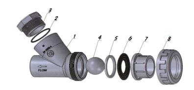
CLAPET A BOULE Modèle Y Femelle à coller. PN16. Corps et boule: PVC. Siège et joint: EPDM CLAPET A BOULE TARAUDE Modèle Y PN10. et boule: PVC. Siège et joint: EPDM Corps
